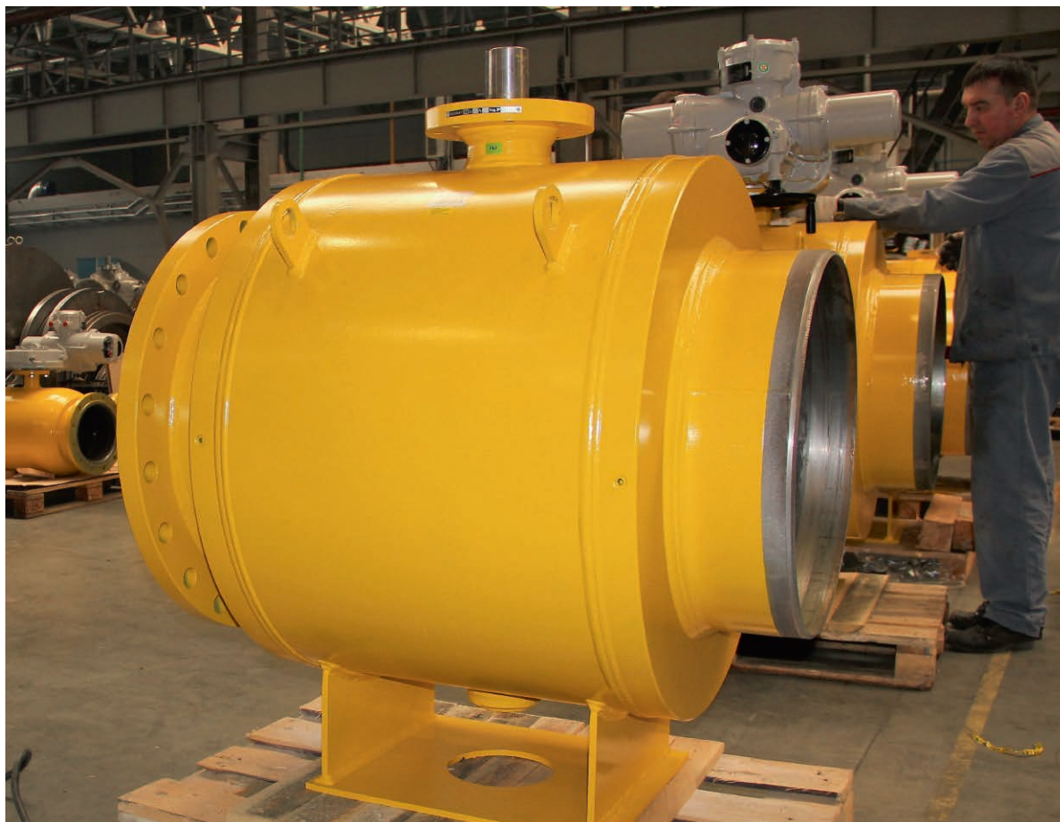
▲ Шаровой кран БРОЕН Балломас с повышенной стойкостью к воздействию рабочей среды (КШГ 71.314.700.16.11.Б.ННВР)
