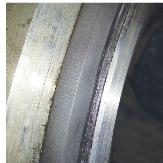
Фото 1. Царапины на PTFE-вставке, появившиеся в процессе эксплуатации
